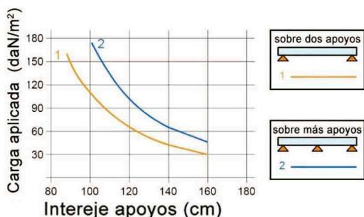
**CARGAS ONDA 76/18 – esp. 6 mm APLICACIÓN CURVA R3500 mm**
